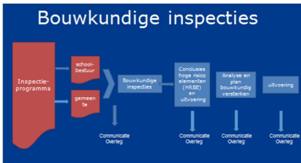
Figuur 4 proces bouwkundige inspecties en bouwkundig versterken
