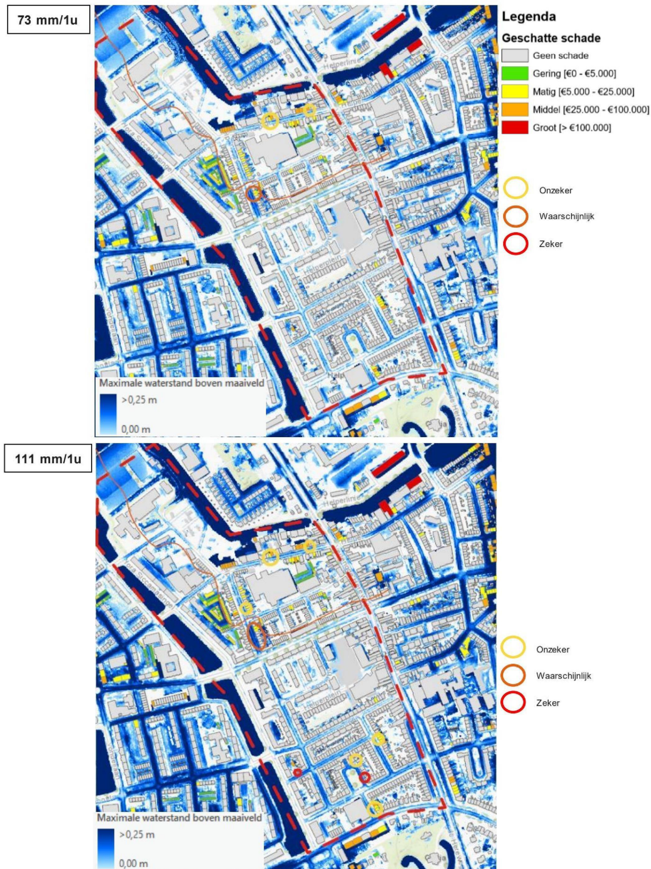
Figuur 9 Potentiële waterschade aan gebouwen bij 73 respectievelijk 111 mm in één uur. Omcirkeld zijn de schadegevallen veroorzaakt door water uit het openbare gebied.
