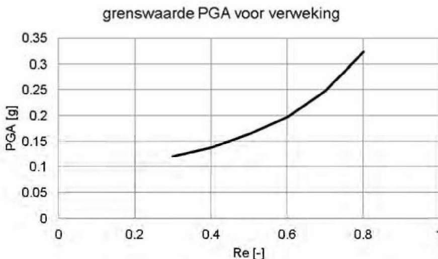
Figuur 4.6 Grenswaarden PGA bij verschillende relatieve dichtheden ( Re ) voor begin verweking
