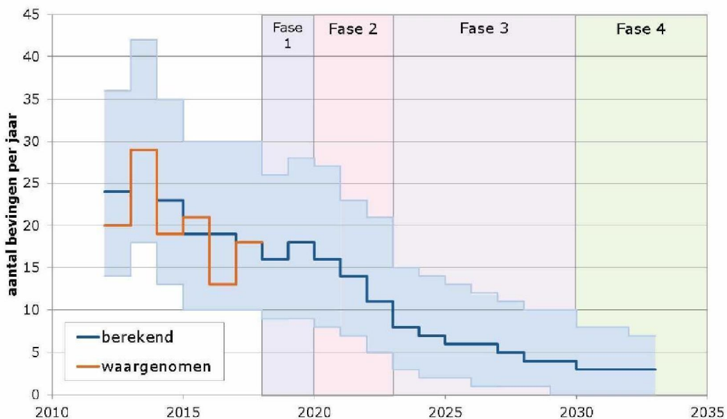
Figuur 2: Berekeningen van de ontwikkeling van het jaarlijks aantal bevingen met een sterkte van 1,5 en hoger voor het afbouwscenario van het kabinet. De blauwe band geeft de onzekerheid op het berekende aantal bevingen weer.
