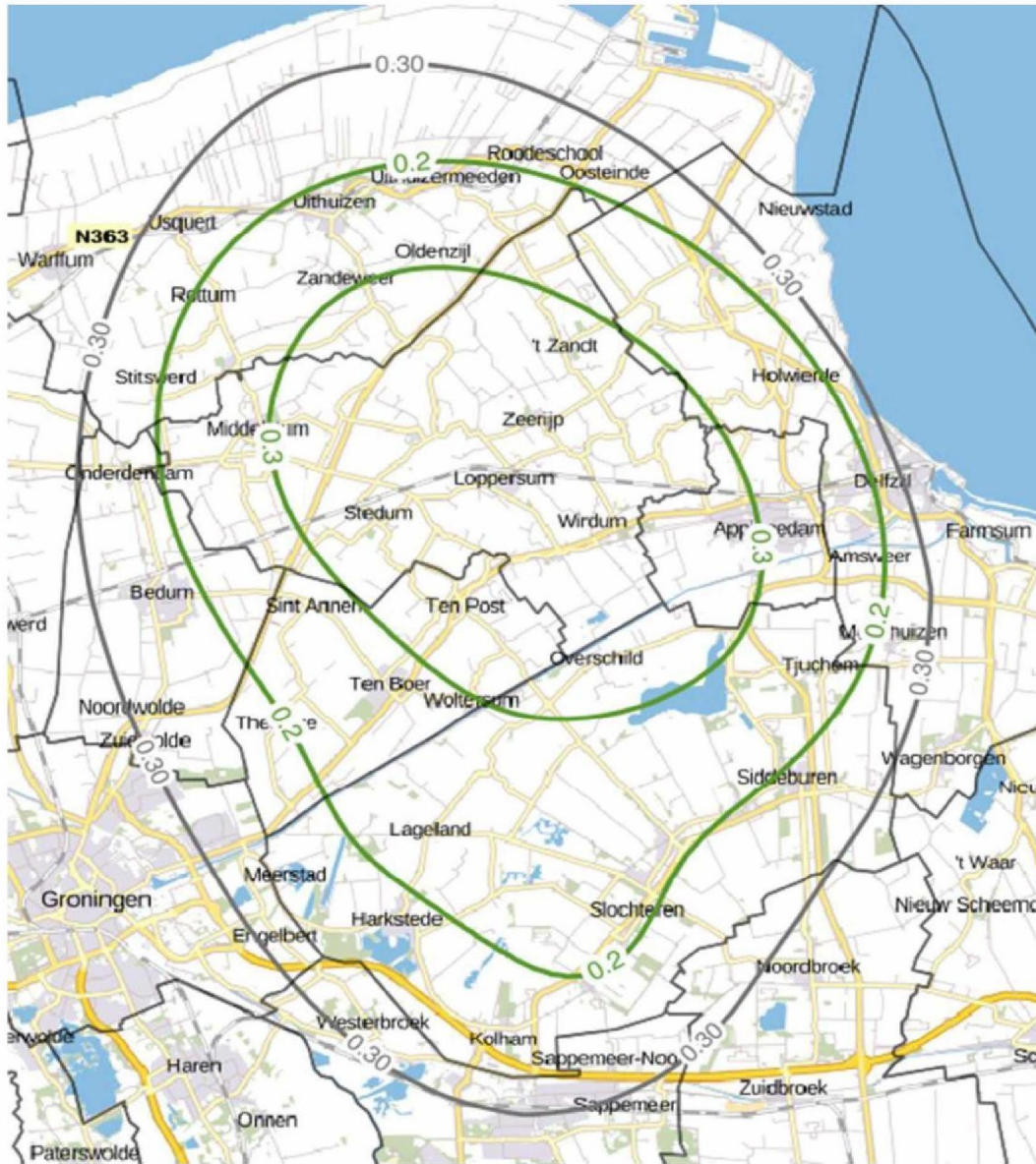
Figuur 1: PGA contourenkaart met PGA-contour van de oude KNMI-kaart uit mei 2013 (grijs, 0.3 contour) en nieuw KNMI-kaart uit oktober 2015 (groen, 0.3 en 0.2 contour)
