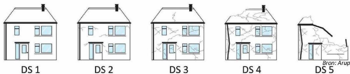
Figuur 5 Schadetoestanden (Damage States) van een gebouw. Waarbij DS1 scheurinitiatie is en DS5 volledig falen.
