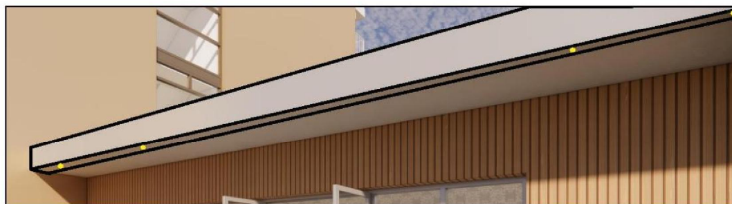
Figuur 14. Voorbeeld creëren van een spleet aan de rand van de boeiboorden (zwart omlijnd) en voorzien van toegangsopeningen van 25 millimeter Ø.
